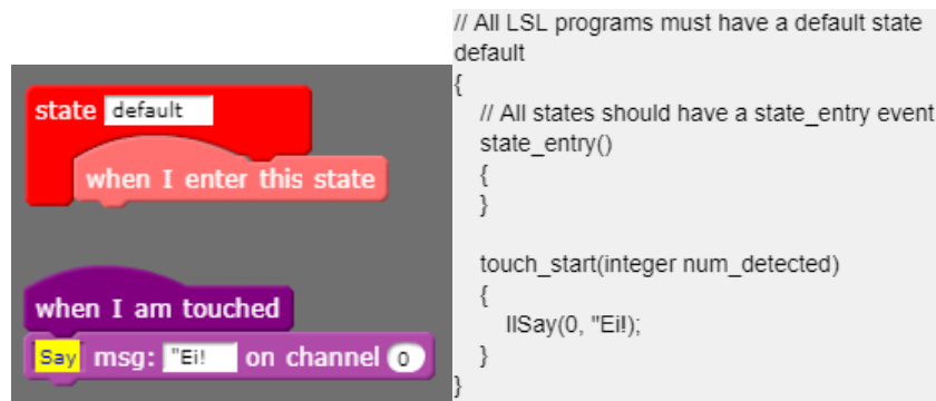
Figura 7.14 - Codificando um script na ferramenta FS2LSL.
