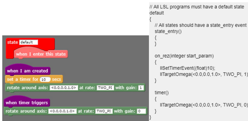
Figura 7.15 - Exemplo de aplicação de blocos visuais para desenvolvimento de um MVI.
