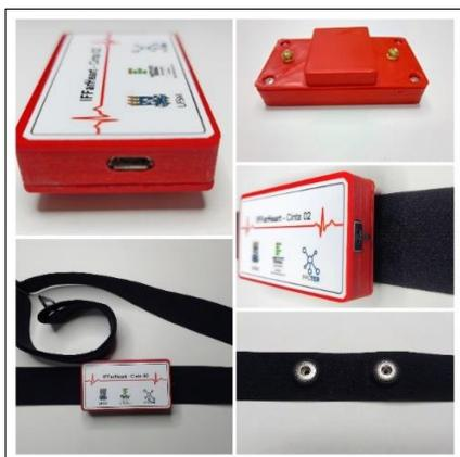
Figura 4 – Protótipo de uma cinta cardíaca
