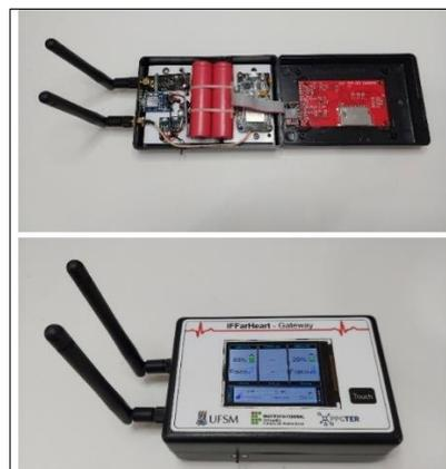
Figura 5 – Protótipo do gateway
