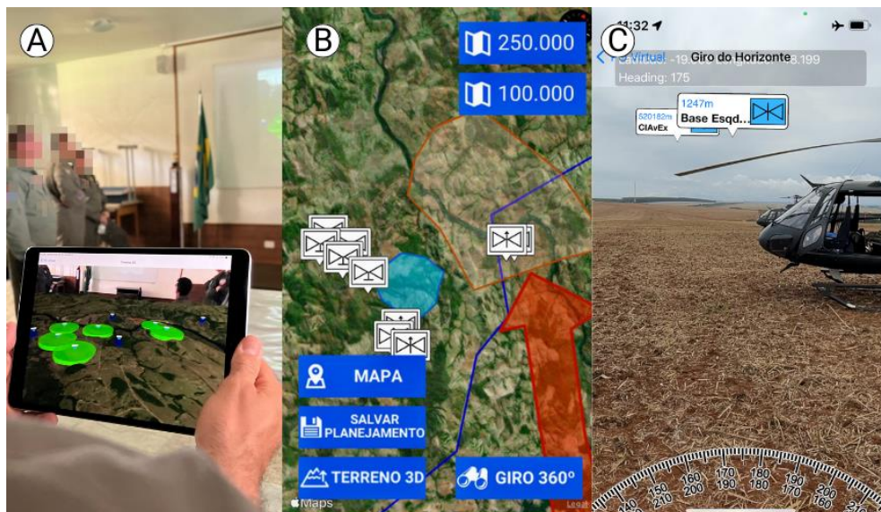
Figura 2. Protótipo da aplicação. A) Terreno 3D sendo projetado por meio da RA. B) Planejamento em Visão de Mapa. C) “Giro do Horizonte” guiado por RA.
