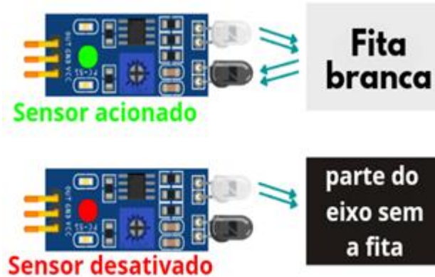
Figura 4: Esquema de funcionamento do sensor infravermelho. Fonte: Elaborado pelos autores (2024).
